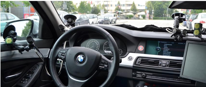
**Abbildung 3.24:** Kameras und Infrarot-Blitzlichter zur kontinuierlichen Erfassung von Blickrichtung und Kopfdrehung des Fahrers
