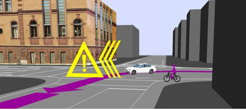
**Abbildung 4.9:** Anzeige im Fahrzeug: Dreidimensionales Warnsymbol an der Stelle des erwarteten Konflikts beim Linksabbiegen.
