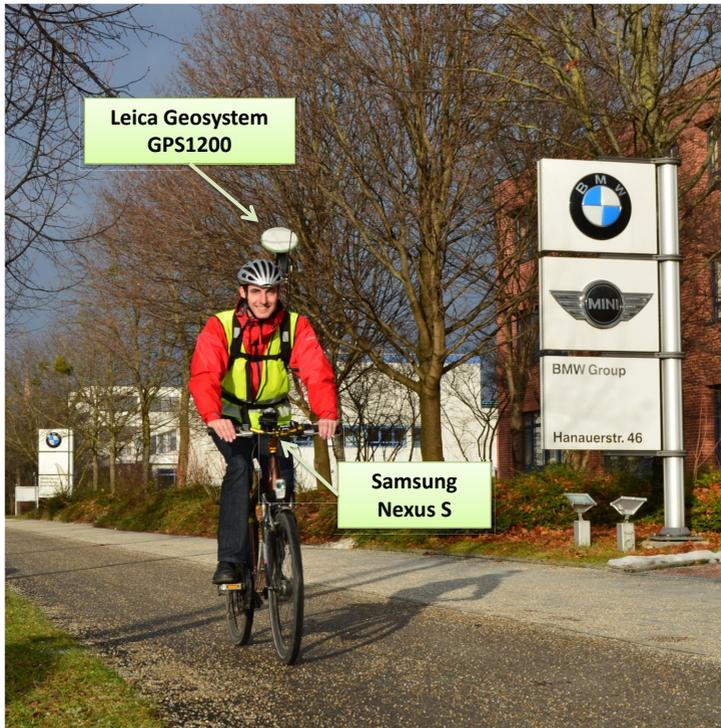
**Abbildung 2.5:** Versuchsaufbau: Das Smartphone befindet sich an der Lenkerstange, während des Referenzsystem in einem speziellen Rucksack auf dem Rücken getragen wird.
