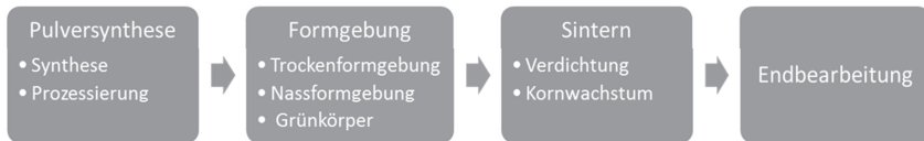
Abbildung 1.1: Schema eines einfachen pulvermetallurgischen Prozesses.
