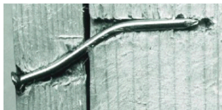
Bild E2-13 Der Nagel wird aus dem Holz herausgezogen.
