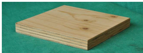
Bild B6-18 Sperrholz mit unterschiedlich dicken Längs- und Quernurnieren.
