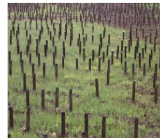
Bild B4-1 Links: Versuchskörper im Labor nach EN 113. Rechts: Freilandversuchskörper nach EN 252. (Rapp und Augusta, 2000)
