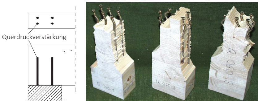
Bild E5-2 Links: Beispiel einer Querdruckverstärkung. Rechts: Aufgetrennte Versuchskörper mit geknickten Schrauben (Bejtka, 2005).
