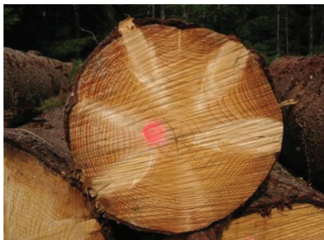
Bild B3-3 Querschnitt mit Astquirl.
