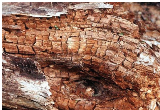
Bild B3-19 Braunfäule mit Würfelbruch.
