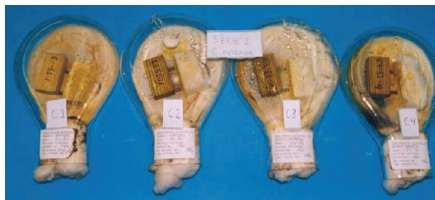
Bild B4-1 Links: Versuchskörper im Labor nach EN 113. Rechts: Freilandversuchskörper nach EN 252. (Rapp und Augusta, 2000)
