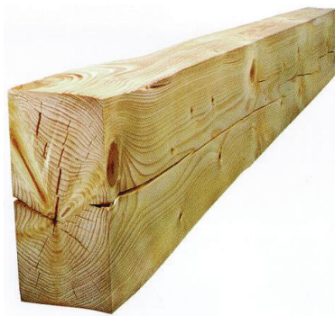
Bild B6-2 Kantholz mit Markröhre, Ästen und Trocknungsrisse. (Studiengemeinschaft Holzleimbau, 1998)
