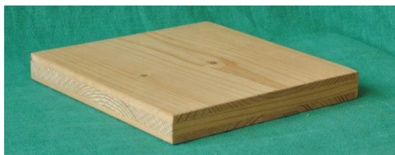
Bild B6-17 Dreischichtige Massivholzplatte.
