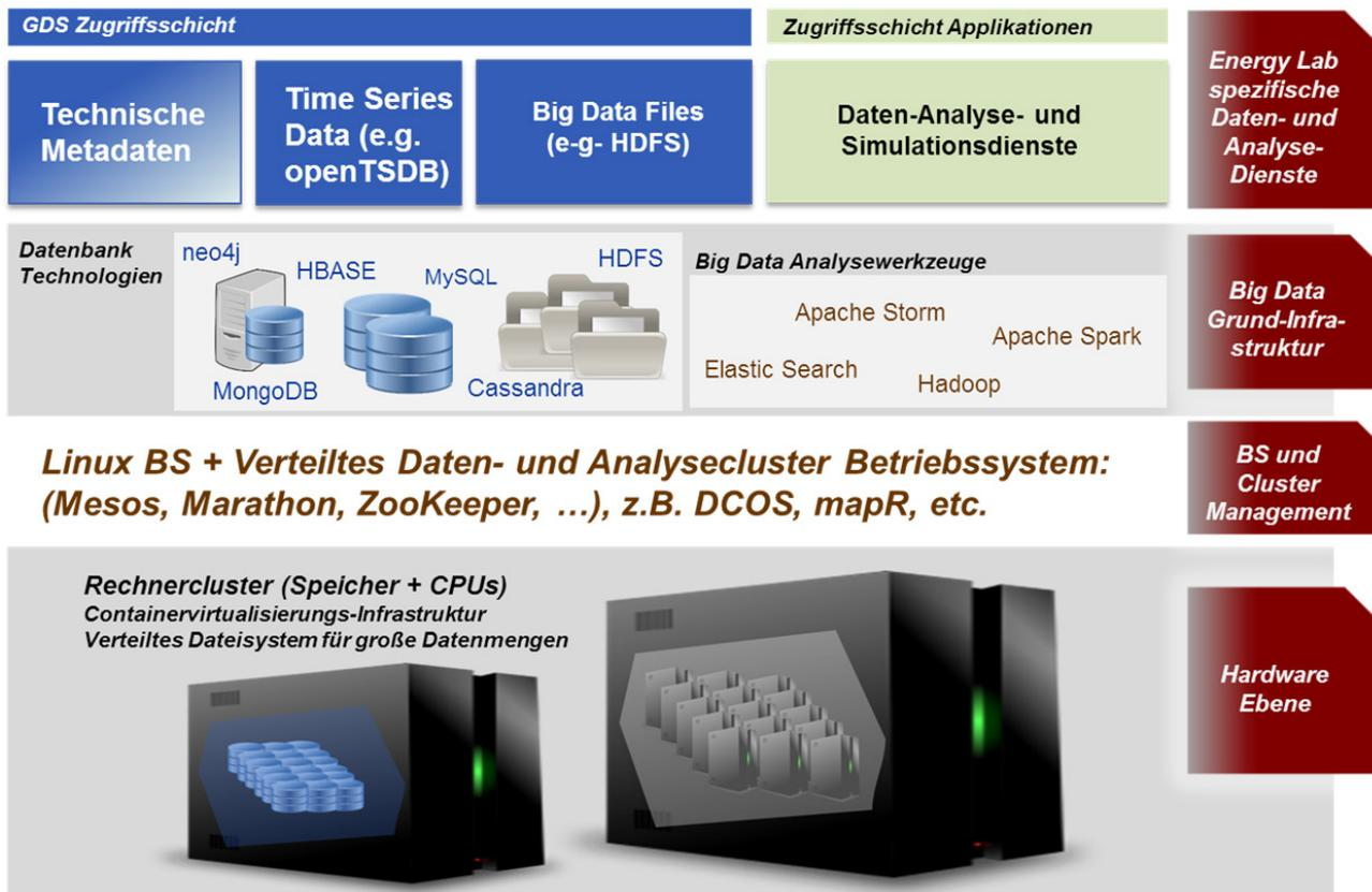
Abb. 43: Laufzeitsystem und grundlegende Systemarchitektur für eine forschungsorientierte „Smart Grid“-Leitstelleninfrastruktur
