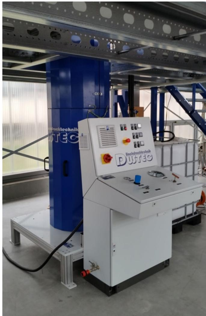
Abb. 29: Unterteil des Autoklaven mit Bedienpult
