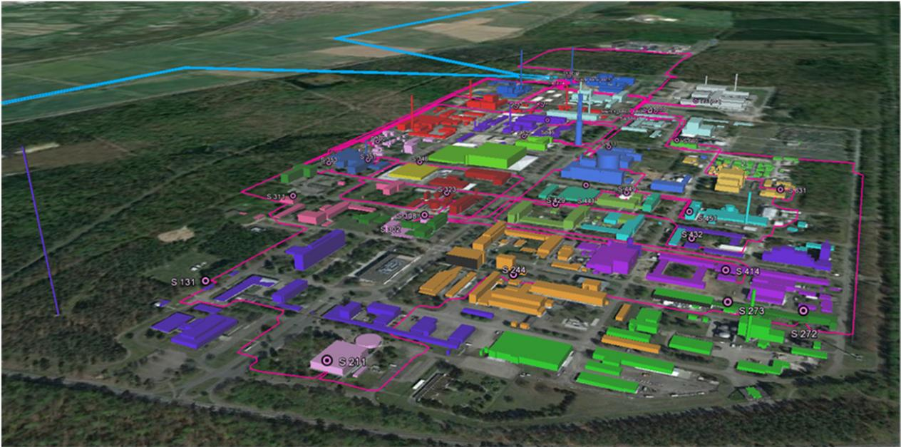
Abb. 3: 20kV-Stromnetz des KIT-Campus Nord in Google Earth (3D-Gebäude: AG Häfele)
