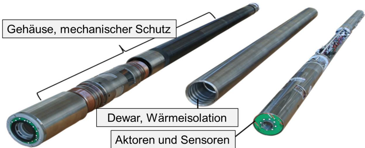
Abb. 27: 3-Ebenen-Aufbau der Sonde: Stabiles Gehäuse, Wärmeisolation und innerer Aufbau
