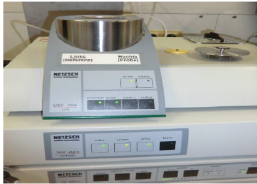
Abbildung 3.5: Das dynamische Differenzialkalorimeter von der Firma Netzsch.
