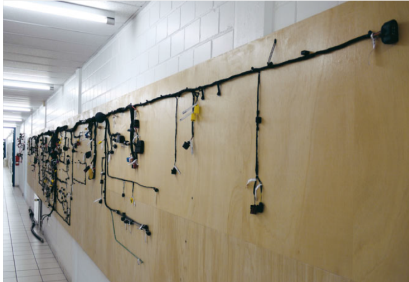
Abbildung 3.5: Kabelsatz des Audi A8 (2011) auf einer Schautafel mit einem Gewicht von ca. 50 kg (Quelle: [22])
