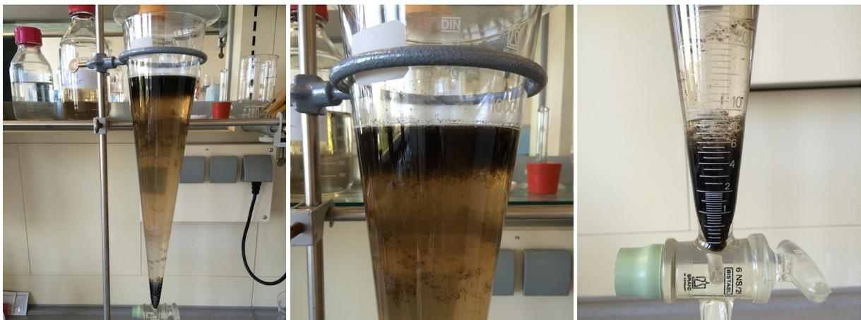
Abb. 4.1.: Versuch V1 - Dichtentrennung nach 2 Tagen ungestörter Sedimentation
