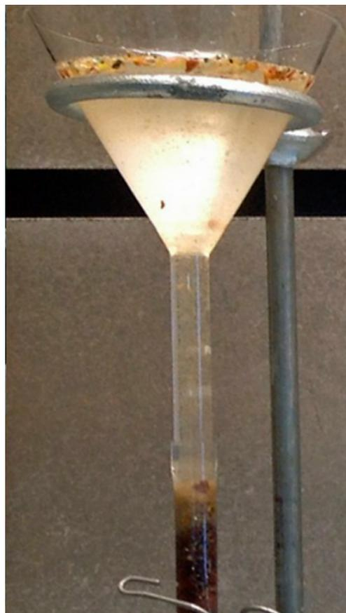
Abb. 2.4.: Dichtentrennapparatur nach Yonkos et al. (2014)
