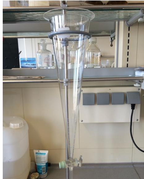
Abb. 3.4.: Aufbau Dichttrennapparatur bestehend aus einem Imhofftrichter mit Glasventil und einem Uhrglas
