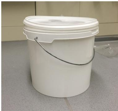
Abb. 3.2.: 5 L Probenahmeimer für Mischwasserproben nach dem Rechen
