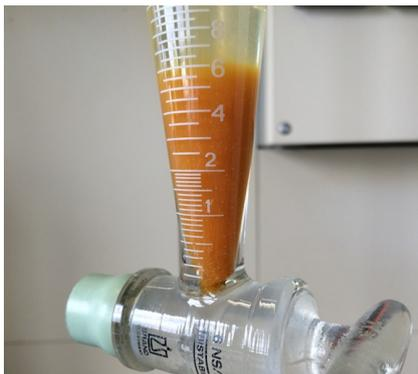
Abb. 4.6.: Versuch V5.1 - Rötlich-brauner Niederschlag nach 24 h Dichtentrennung
