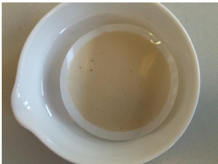
Abb. B.15.: Versuch V8 - Filter einer Blindprobe nach Trocknen: Kontamination des Filters ist mit bloßem Auge sichtbar
