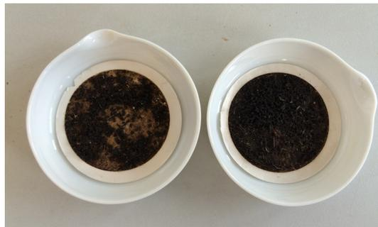
Abb. 4.3.: Versuch V2 - Filter 1 (links) und Filter 2 (rechts) nach teilweiser Vakuumfiltration der aufgeschwommenen Partikel nach Dichtentrennung
