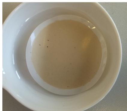
Abb. 4.12.: Versuch V8 - Filter nach Vakuumfiltration der Blindprobe
