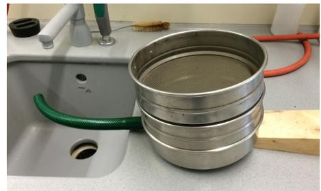
Abb. 3.3.: Siebturm aus Edelstahl-Analysesieben (1 mm und 63  $\mu\text{m}$ )
