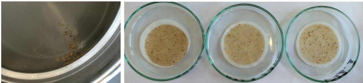
Abb. 4.8.: Versuch V6 - Waschen der Probe V6.3 über einem 63  $\mu\text{m}$  Analysesieb zeigt Organikreste nach WPO (links); Filter der 3 Teilversuche V 6.1 (5x  $\text{H}_2\text{O}_2$ -Zugabe), V 6.2 (7x  $\text{H}_2\text{O}_2$ -Zugabe) und V 6.3 (9x  $\text{H}_2\text{O}_2$ -Zugabe) (v.l.n.r) (rechts)
