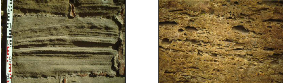
Abb. 2.29: Selektive Verwitterung in Abhängigkeit der Textur (links) und einzelner verwitterungsanfälliger Gesteinskomponenten (rechts), Bildhöhe links ca. 50 cm, Bildbreite rechts ca. 50 cm [44]
