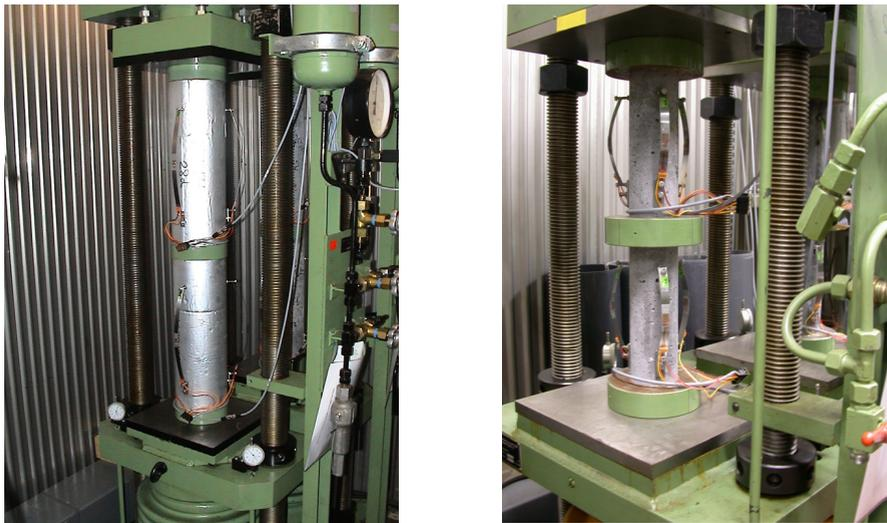
Bild 3.3: Je zwei Leichtbetonproben wurden übereinander in die hydraulische Belastungseinrichtung für die Kriechversuche eingebaut (links: mit einer mit Butylkautschuk beschichteter Alufolie versiegelte Leichtbetonproben  $\varnothing \times h$  150 mm x 450 mm; rechts: unversiegelt gelagerte Proben  $\varnothing \times h$  75 mm x 225 mm)
