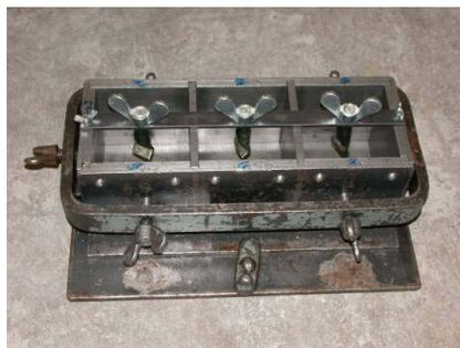
Bild A-3.5: Spezielle Schalungselemente zur Herstellung der Prüfkörper;
