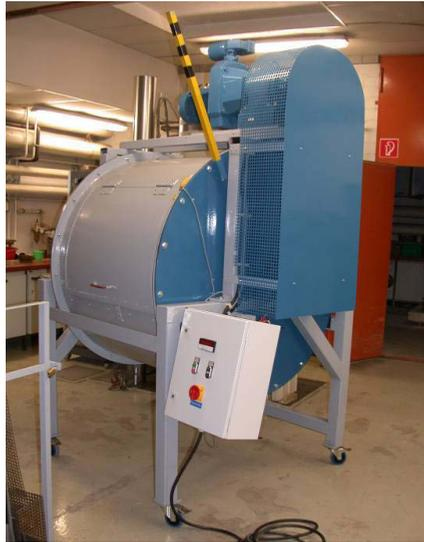
*Bild A-3.1: Karlsruher Verschleißtrommel*
