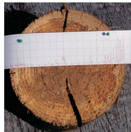
Für Nachweis und Dokumentation von Innenfäule in Holzmasten hat sich die Bohrwiderstandsmessung besonders bewährt. Diese Messtechnik findet zuverlässig die holzversprödende Braunfäule, welche als dominanter und versagensrelevanter Fäuletyp in Holzmasten auftritt.
