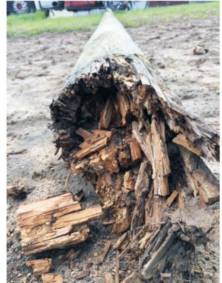
Fäulebedingter Mastbruch. Fäuletyp: Braunfäule (Innenfäule an der Grundlinie). Fäuleerreger dringen meist durch Trocknungsrisse in den Mast ein und überwinden so auch Schutzimprägnierungen oder Schutzanstriche. Durch Stockfäule oder Lagerfäule können sie gelegentlich auch schon im Mast sein.
