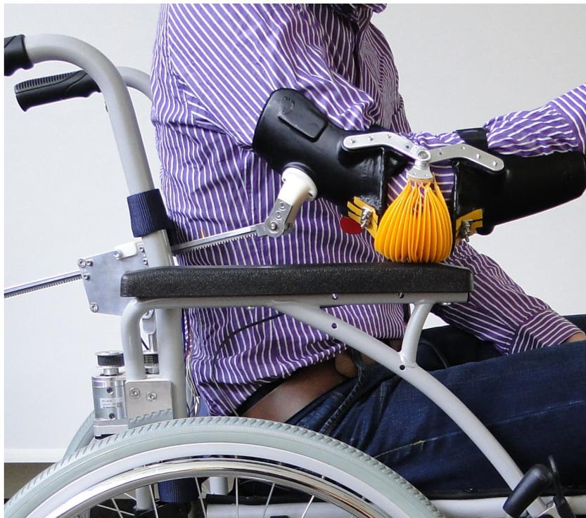
Abb. 2.2: Gesamtsystem der aktiven Hybrid-Orthese [188]
