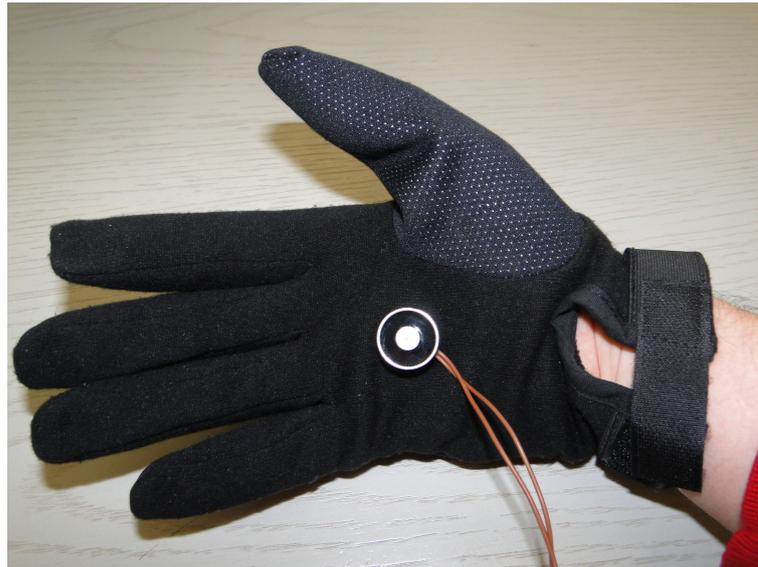
Abb. 2.5: Neuartig entwickelter Magnethandschuh mit Elektromagnet
