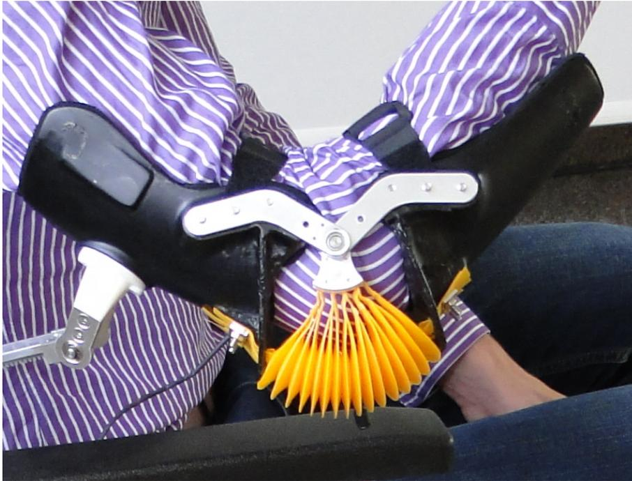
Abb. 2.6: Ellbogenorthese mit flexiblem Fluidaktor [188]
