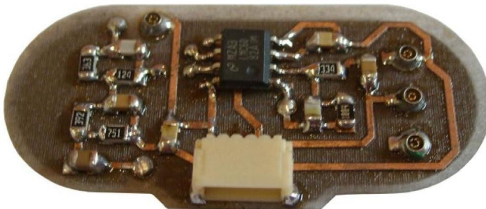
Abb. 3.27: Signalverarbeitungsmodul des entwickelten EMG-Sensors
