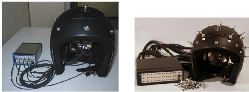
Abb. 1.12: 8-Kanal und 27-Kanal Helm zur EEG-Messung aus [110]
