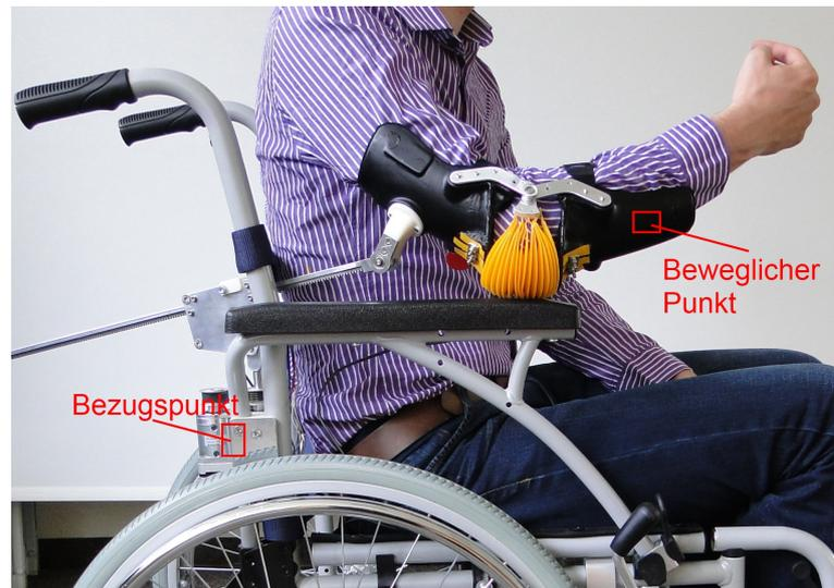
Abb. 2.23: Beispielhafte Anordnung der neuen Beschleunigungssensoren für eine Positionsbestimmung der Ellbogenorthese [188]
