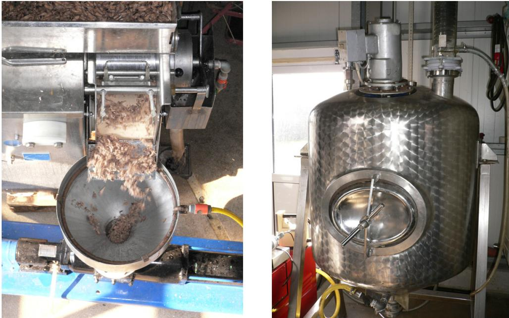
Abb. 4.2: Mechanische Vorbehandlung der Shrimp-Schalen in der Firma SeeLab BÜsum (links) und Fermentation (rechts)
