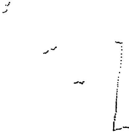
Abbildung 2.6 Ausschnitt eines Laserscans mit drei Personen neben einer Wand.
