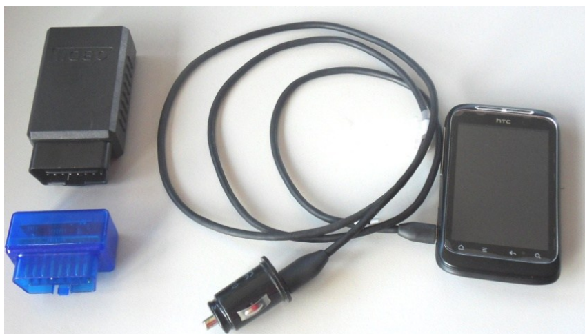
Abbildung 24: Verwendetes Smartphone mit Stromversorgung und verschiedenen OBD-Adaptoren zur Erfassung von Fahrtmessungen.
