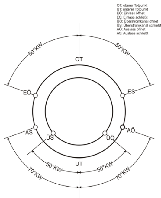
Abbildung 3.1: Geänderte Öffnungs- und Schließzeiten des verwendeten Forschungsmotors
