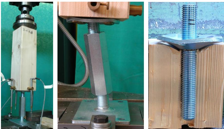
Abbildung 2: Druckversuch PfostenrÄger 10921.00 (links), Ausknicken des PfostenrÄgers (Mitte) und geöffneter Prüfkörper nach Versuchsdurchführung (rechts)
