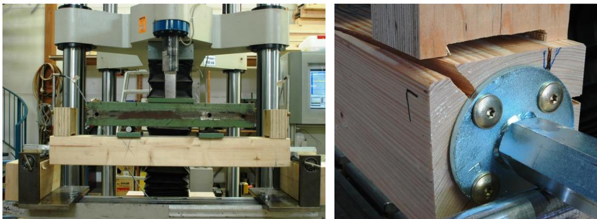
Abbildung 6: Querkraftversuch PfostenrÄger 10921.00 (links), Querkzugversagen des Holzes (rechts)
