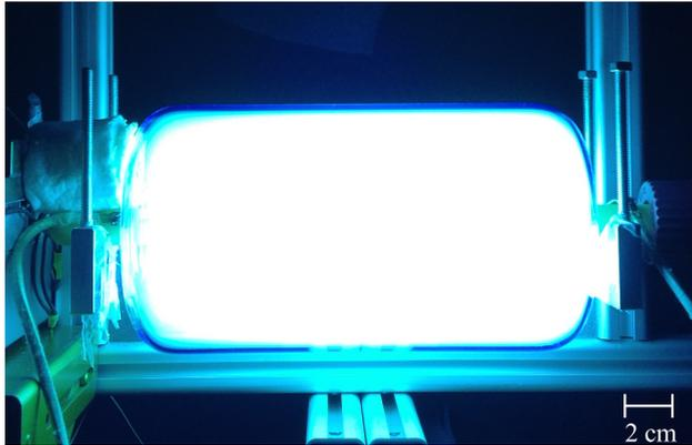
Abbildung 5.28: Fotografie der Versuchslampe Nr. 3 mit einem Puffergasdruck von  $p_{Ar} = 0,3$  mbar bei einer Lampenleistung von  $P_{Lampe} = 1,1$  kW, betrieben am JFET-Vollbrückenwechselrichter
