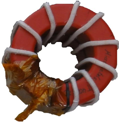
Abbildung 4.9: Fotografie der Resonanzdrossel aus Eisenpulverkernen
