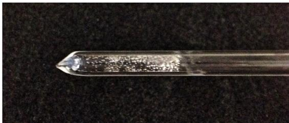
Abbildung 4.32: Fotografie des Lampenappendixes nach dem Betrieb der Versuchslampe Nr. 3 bei  $P_{\text{Lampe}} = 1000 \text{ W}$
