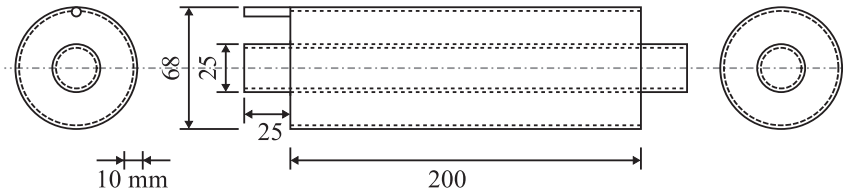
Abbildung 3.1: Zeichnung des koaxialen Lampenkörpers für bis zu 500 W Lampenleistung, der für die Untersuchungen in dieser Arbeit verwendet wird. Weitere Lampenkörper für größere Lampenleistungen bis 1,2 kW werden mit Außenrohrdurchmessern von d_a = 80 \text{ mm} und d_a = 110 \text{ mm} gefertigt. Alle Maße sind in Millimetern angegeben.
