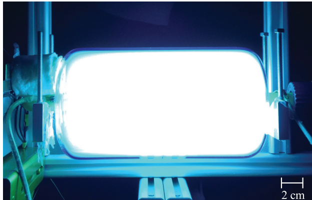
Abbildung 5.28: Fotografie der Versuchslampe Nr. 3 mit einem Puffergasdruck von p_{\text{Ar}} = 0,3 mbar bei einer Lampenleistung von P_{\text{Lampe}} = 1,1 kW, betrieben am JFET-Vollbrückenwechselrichter
