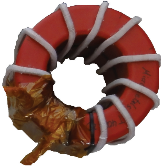
Abbildung 4.9: Fotografie der Resonanzdrossel aus Eisenpulverkernen
