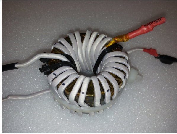
Abbildung 4.12: Fotografie des aufgebauten 1:1 Transformators mit 3 gestapelten Fair-Rite FT 240-52 Ringkernen mit jeweils 11 Windungen. Es wird eine Litze mit 480 Einzeladern mit je 100 \mu\text{m} Durchmesser verwendet.
