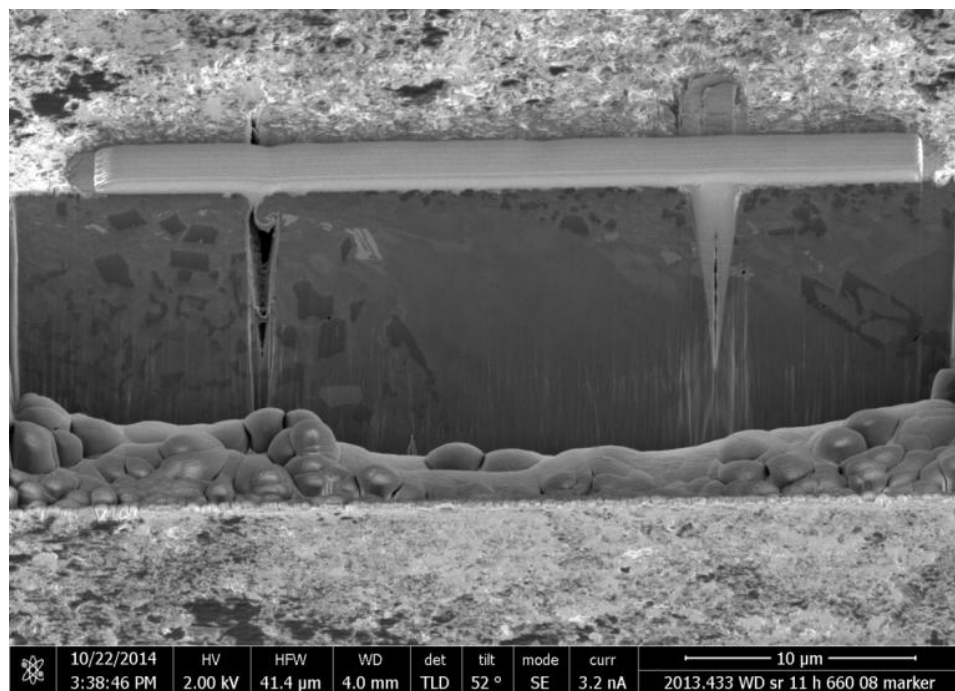
(b) Querschnitt durch einen Marker nach tribologischer Belastung einer mit WD endbearbeiteten Scheibe. Der rechte Graben ist mit Platin gefüllt, der linke Graben blieb ungefüllt. Versuch bei 35 MPa; 0,8 m/s; 32 000 m Gleitweg. Bewegungsrichtung des Stifts von rechts nach links.
