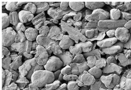
Abb. 6.4: a) Spezifikationen Graphitanode. b) Mikrostrukturparameter (ermittelt wie in [20]). c) REM-Aufnahmen der Anodenoberfläche
