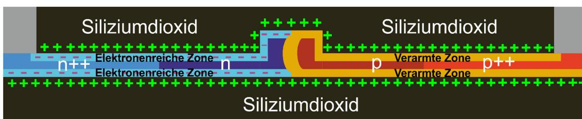
Abbildung 53: pn-Modulator mit aufgeladenem Siliziumdioxid
