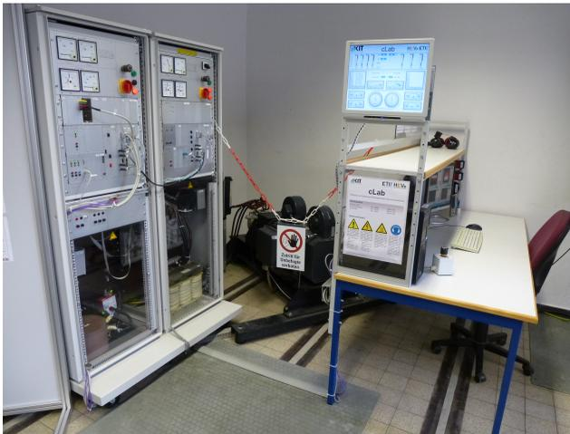
Abbildung 5.1: Verwendeter Motorprüfstand. Zu sehen sind der Maschinensatz, der PC zur Bedienung und die zwei Schaltschränke, die jeweils Leistungselektronik, Signalverarbeitung und Messtechnik beinhalten.
