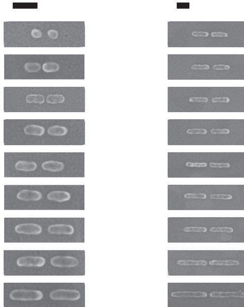
**Abbildung 4.2:** Rasterelektronenmikroskopaufnahme von auf ITO hergestellten optischen Zweiarm-Antenne aus Aluminium mit nomineller Breite und Höhe 30 nm sowie Spaltweite von 20 nm. Der Maßstabsbalken entspricht jeweils 100 nm. links: 50 bis 130 nm, rechts: 140 bis 200, 250, 300 nm.
