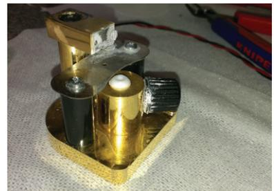
**Abbildung 8.3:** Ätzanlagen zum elektrochemischen Ätzen von (a) Gold- und (b) Wolframspitzen.
