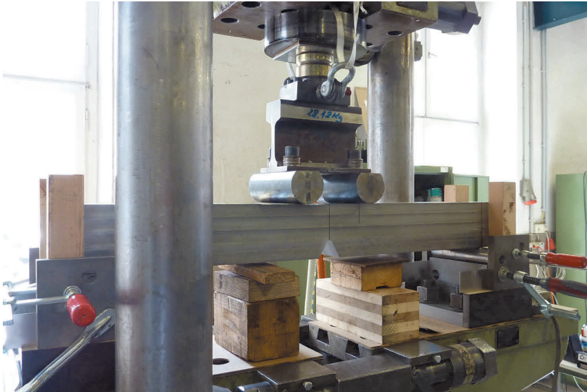
Bild D.6: Versuchsaufbau zum Anschwingen der Proben, hier Wanddicke 112,5 mm
