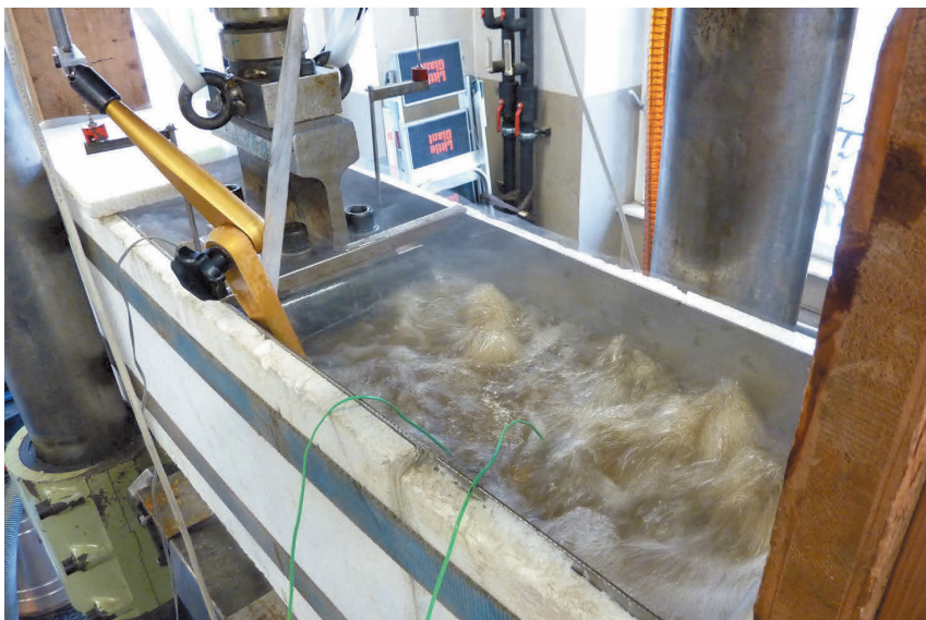
Bild D.7: Versuchsaufbau der Prüfung bei -50\text{ }^{\circ}\text{C}
