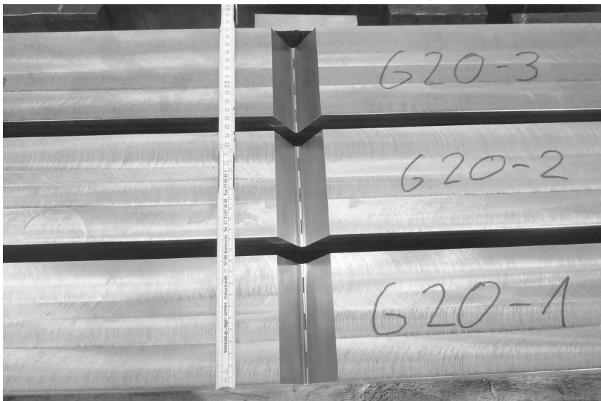
Bild D.5: Fertige Probekörper, Platte 112,5 mm, Werkstoff G20Mn5
