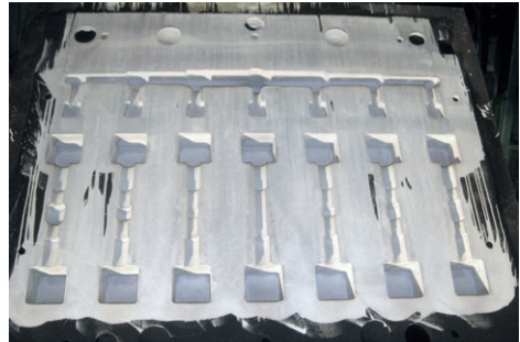
Bild 3.4: Fertiger eingeformter Oberkasten, Gießerei B
