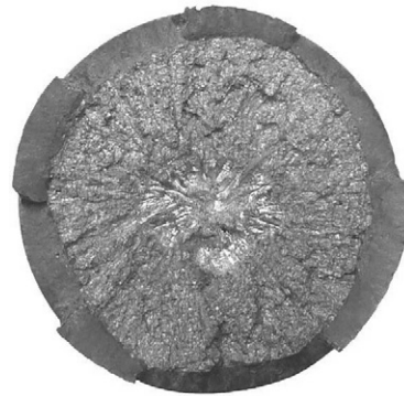
Bild 3.32: Bruchfläche der Probe C11-3
