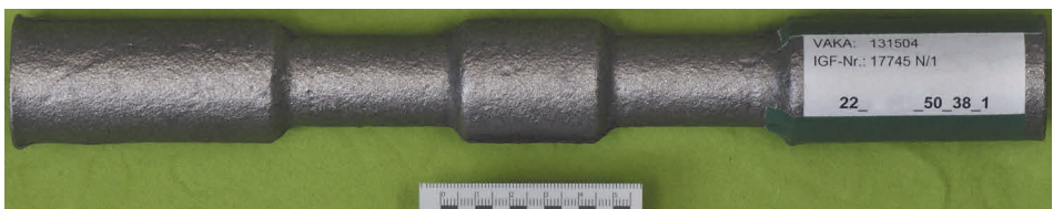
Bild 3.7: Exemplarisch, Probekörper der Gießerei B, Werkstoff G22NiMoCr5-6, 10 mm Aufdickung über eine Länge von 50 mm
