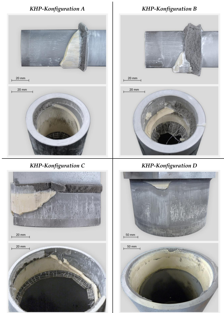
Abbildung 6.19 Exemplarische Bruchbilder der KHP-Konfigurationen A – D ; Klebstoff PUR
