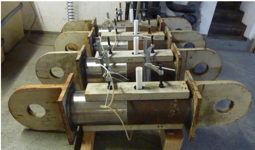
Abbildung 6.11 Klebtechnische Fertigung der Großrohrproben Konfiguration D
