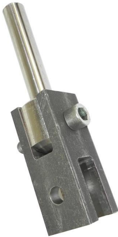
Abbildung 5.6 Prüfvorrichtung zur doppelgelenkigen Anbindung der Probekörper an die Prüfmaschine
