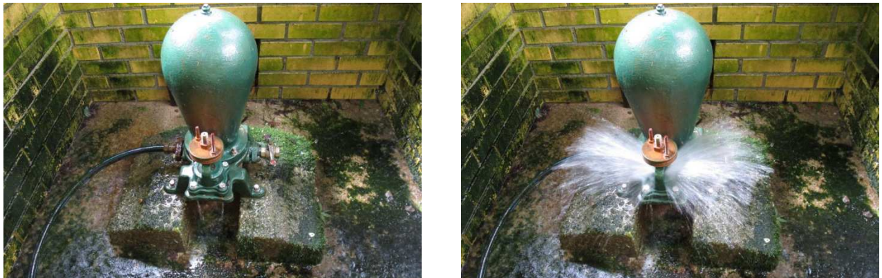
Abbildung 3.1: Hydraulischer Widder in der „Ladephase“ 15 (links) und beim Ausstoßen des Triebwassers 16 (rechts)
