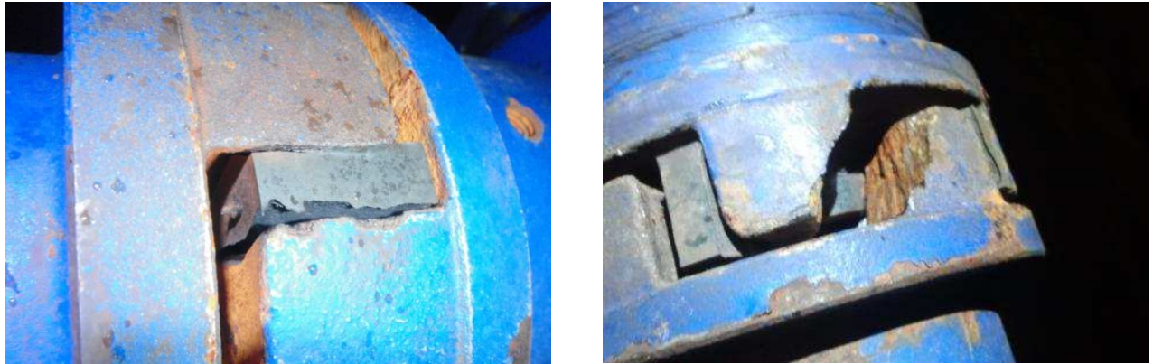
Abbildung 4.29: Verschleißerscheinungen an Polymernocken (links) und Gussnaben (rechts) der Kupplungen zwischen PAT und Getriebe
