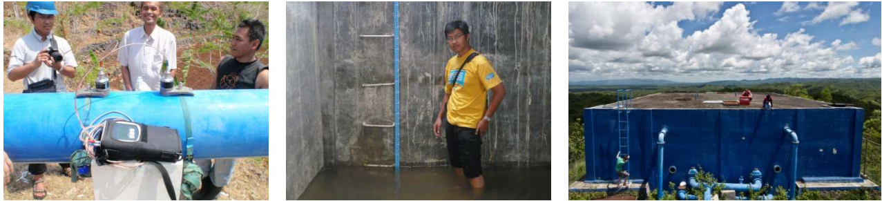
Abbildung 4.11: Durchflussmessungen mittels Ultraschallmessgerät in Zusammenarbeit mit dem Betreiber PU und der Universität Gadjah Mada (UGM), Yogyakarta , (links) in Bribin und am Verteilspeicher Kaligoro 26 (Mitte und rechts)
