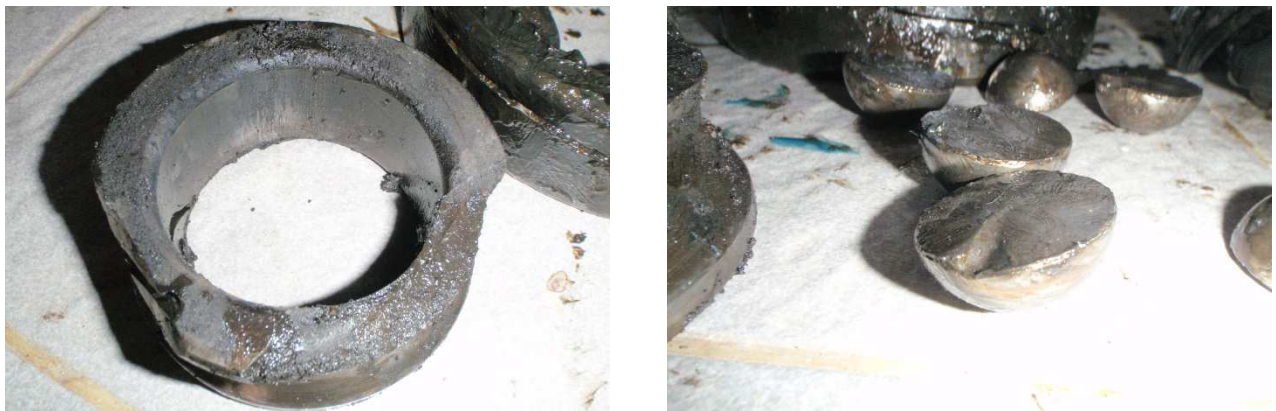
Abbildung 4.28: Bruch von Lagerring (links) und Wälzkörper (rechts)
