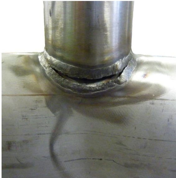
Bild A.5 Schweißnahtversagen – Versuchskörper XD-T-0
