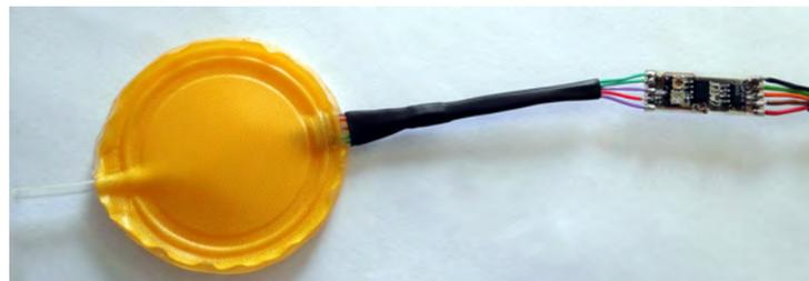
Abb. 3.13.: Testaufbau des im Aktor integrierten Drucksensors, links: Aktor mit integrierten resistiven Sensor, rechts: Platine mit Verstärkerschaltung und AD Wandlung
