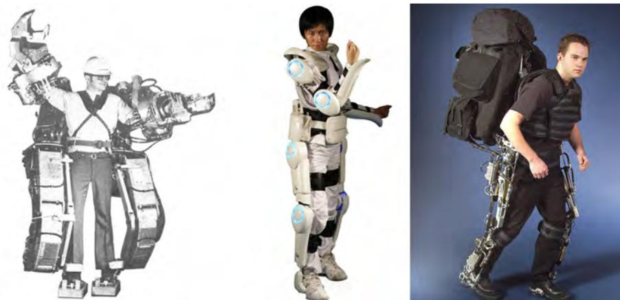
Abb. 1.3.: links: Ganzkörper Exoskelett Handiman von 1950, Mitte: Ganzkörper Exoskelett Hal-5 von [176], rechts: Exoskelett für die unteren Extremitäten der Universität Berkely [99]
