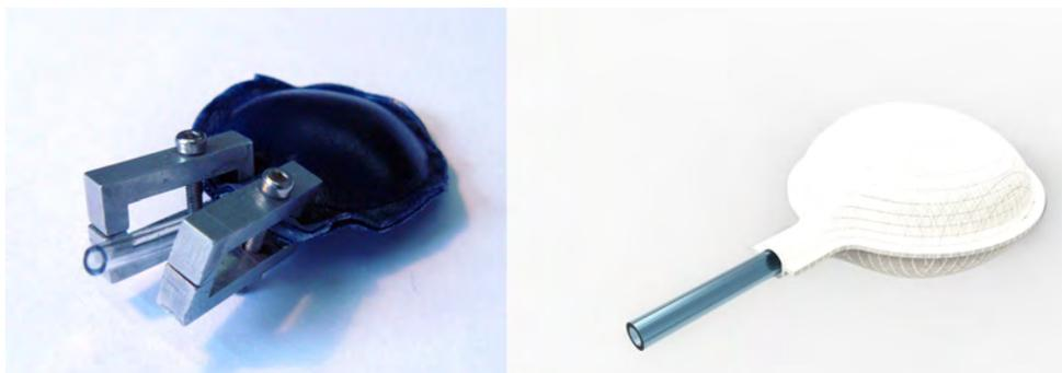
Abb. 9.18.: links: Klemmung links und rechts der Schlaucheinschweißstelle zur Entlastung der Schweißverbindung, rechts: CAD Modell eines alternativen Kugelaktors bei den der Übergang zum Schlauch nicht so stark belastet ist
