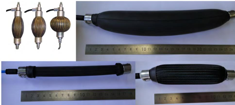
Abb. 1.4.: links oben: McKibbenaktor der Universität Brüssel [20], rechts oben: McKibbenaktor ohne Verstärkung mit Innendruck, links unten: McKibbenaktor ohne Innendruck, rechts unten: McKibbenaktor mit Verstärkung und Innendruck
