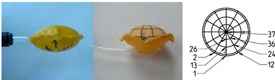
Abb. 4.4.: links: normaler Kugelaktor (mit Loch an der Naht), Mitte: Spezieller Kugelaktor mit Druckluftanschluss auf der Fläche, rechts: Messmuster auf der Aktoroberfläche
