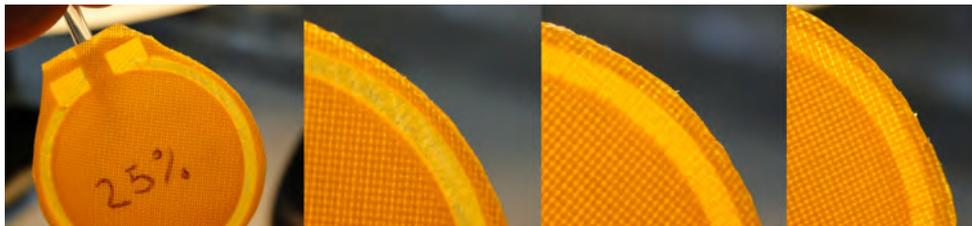
Abb. 9.4.: Verschiedene Nahtdicken nach dem Schweißen, links gesamter Aktor, nach rechts 25%, 45% und 75% Naht
