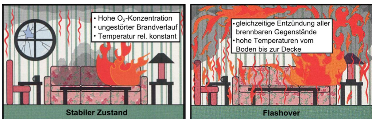
Abbildung 2.4: Entwicklung eines Brandes bis zum Flashover [6].
