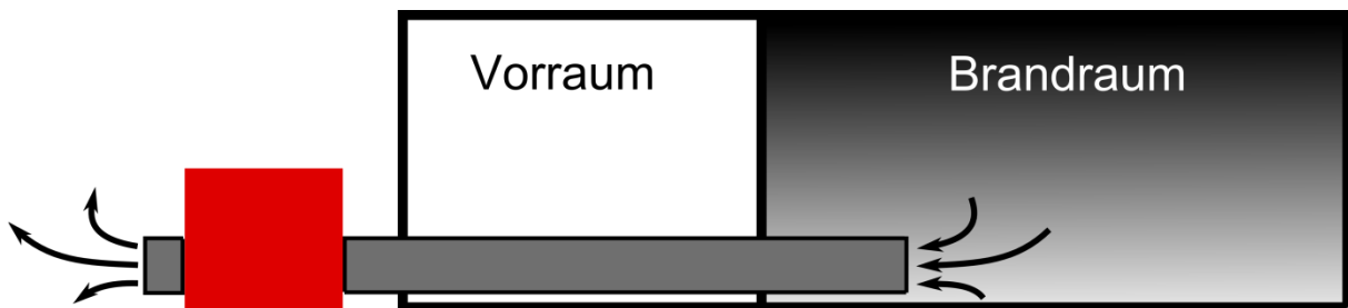
Abbildung 3.4: Entrauchung eines Brandraumes mittels Unterdruckventilation. Die notwendigen Nachströmöffnungen sind nicht explizit in der Abbildung dargestellt.
