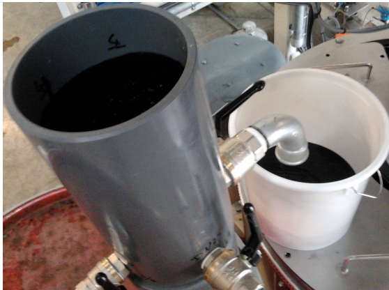
Abbildung D.13 – Versuchsaufbau zur Erfassung des Ausflussverhaltens von Biosyncrude durch verschiedene Kugelventile
