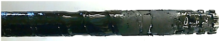
Abbildung 5.12 – Schnecke nach Verstopfung des Extruders infolge einer feststoffreichen Zone in der Austragszone [Nic14b]
