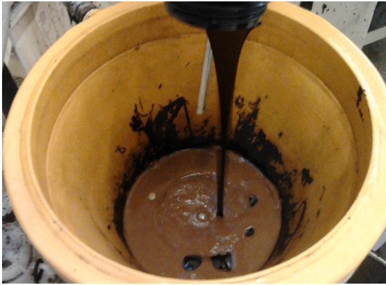
Abbildung 5.8 – Emulgieren von 1 Liter Schwelwasser mit 1 Liter Schwelteer
