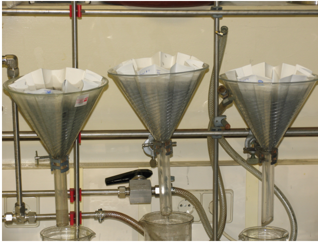
Abbildung 3.4 – Filtration der Suspension, stark verdünnt mit Ethanol
