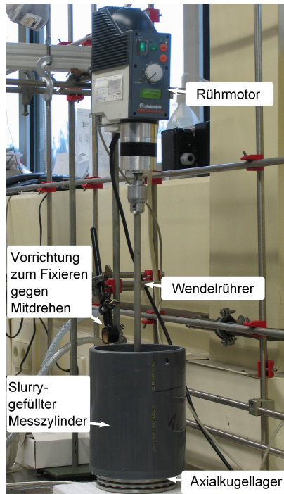
Abbildung 3.27 – Aufbau des Rührversuches
