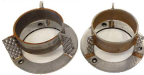
Abbildung 3.11 – Rührer mit perforierten Paddeln und unterschiedlichen Durchmessern: d_{\text{links}} = 152 \text{ mm} (Paddellänge 25 mm); d_{\text{rechts}} = 138 \text{ mm} (Paddellänge 18 mm)
