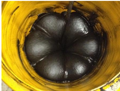
Abbildung 3.9 – Sekundärzirkulation im Laborkolloidmischer mit charakteristischen Wirbeln (35 m.-% ungemahlener Strohkokks in 2 Liter Ethylenglykol) bei 990 \text{ min}^{-1}
