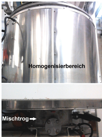
(a) vollautomatische Batch-Mischanlage
