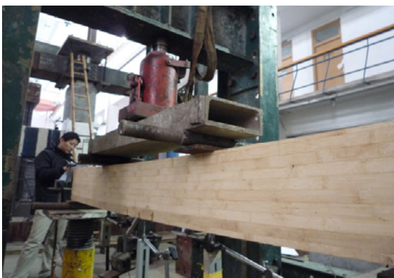
Abb. 6 Materialtest an Bambus-Schichtbalken
