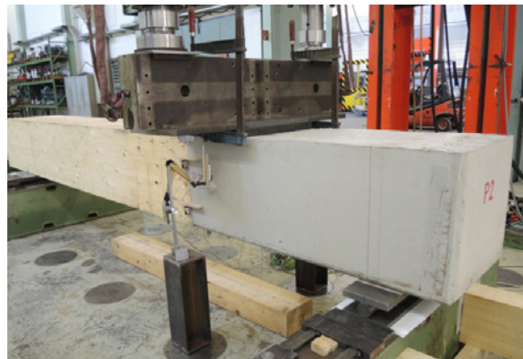
Abb. 11: Ansicht des Versuchsaufbaus des 3Punkt-Biegeversuchs mit dem Prüfkörper P2
