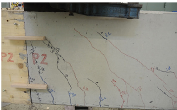
Abb. 12: Rissbildung im Stahlbetonteil des Prüfkörpers P2 im Traglastbereich
