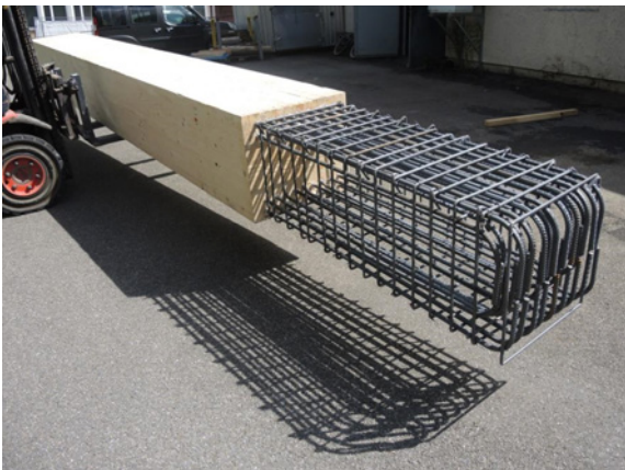
Abb. 8: Ansicht des Prüfkörpers P2 mit eingeklebten Betonstahlstäben einschließlich Bügelbewehrung
