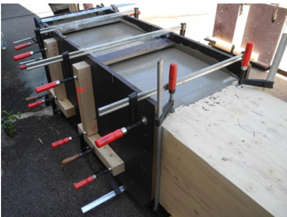
Abb. 9: Eingeschalteter und mit Beton verfüllter Stahlbetonfortsatz des Prüfkörpers P2
