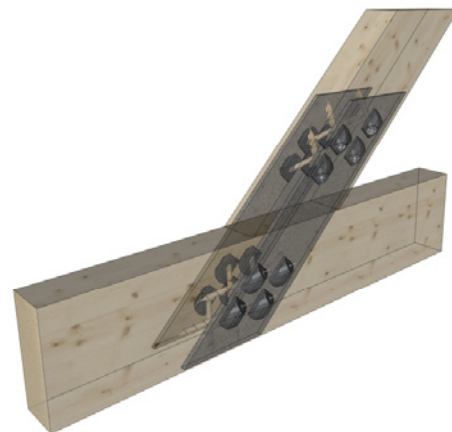
Abb. 4 Zugscherverbindung mit außenliegenden Stahllaschen und Winkelscheiben
