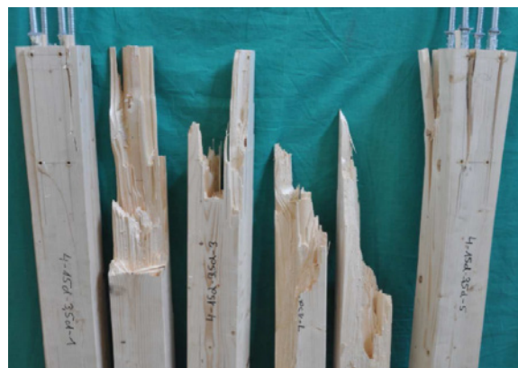
Abb. 3 Prüfkörper mit eingeklebten Gewindestangen nach der Versuchsdurchführung
