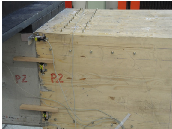
Abb. 10: Ansicht der in zwei Achsen im Stahlbeton-Holz-Anschlussbereich angeordneten Querkzugbewehrung des Prüfkörpers P2
