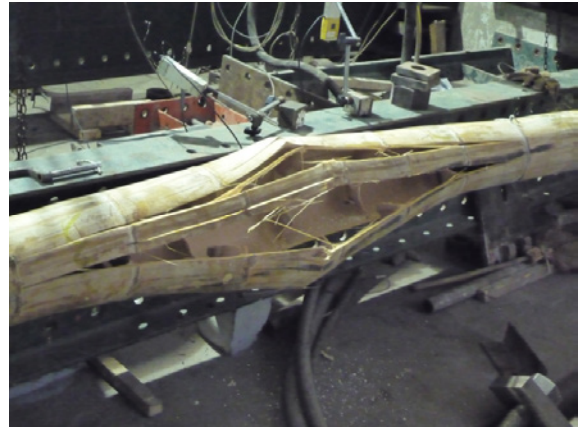
Abb. 7 Materialtest an Bambus-Rohren
