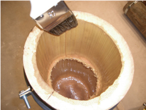
Abb. 8 Vorbereitung der Bambusrohre
