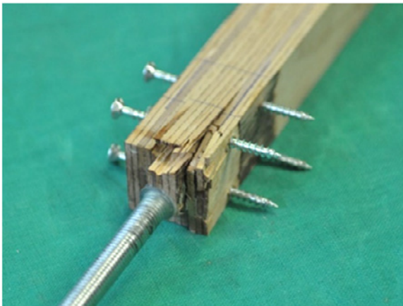
Abb. 17 Prüfkörper des Typs Q mit Randabständen von 1,5 \cdot d
