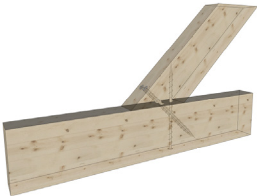
Abb. 5 Aufteilung der Anschlusskraft in unterschiedlich geneigt Schrauben
