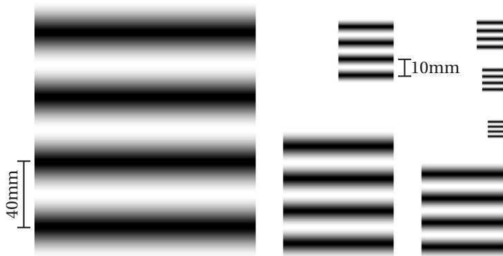
Abbildung 7.7: Darstellung der auf der Testtafel angebrachten Modulationsmuster.
