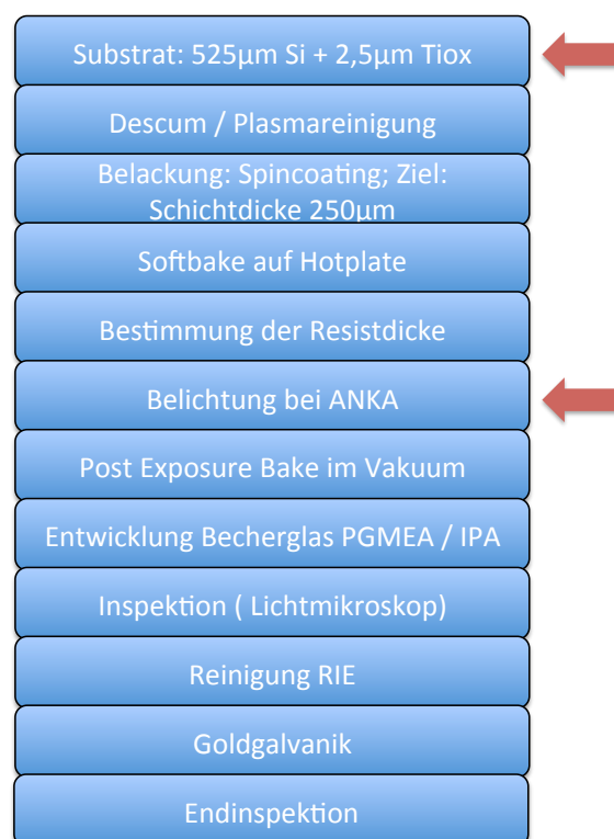
Abbildung 4.1: Prinzipieller Prozess zur röntgenlithographischen Herstellung von Gitterstrukturen. Die roten Pfeile markieren die beiden Teilprozesse, die in der vorliegenden Arbeit als Startpunkte für die Optimierung des Gesamtprozesses genutzt werden: Wahl des Substrats und die lithographische Strukturierung.
