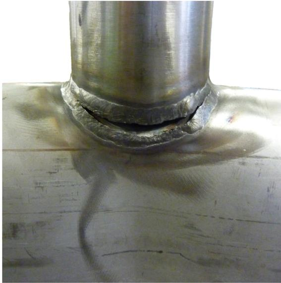
Bild A.5 Schweißnahtversagen – Versuchskörper XD-T-0
