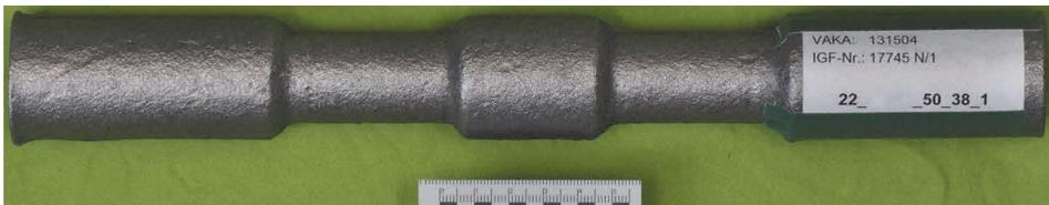
**Bild 3.7:** Exemplarisch, Probekörper der Gießerei B, Werkstoff G22NiMoCr5-6, 10 mm Aufdickung über eine Länge von 50 mm
