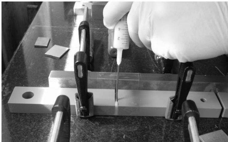
Abbildung 5.5 Klebstoffapplikation durch Injektion in den Spalt der Flachproben
