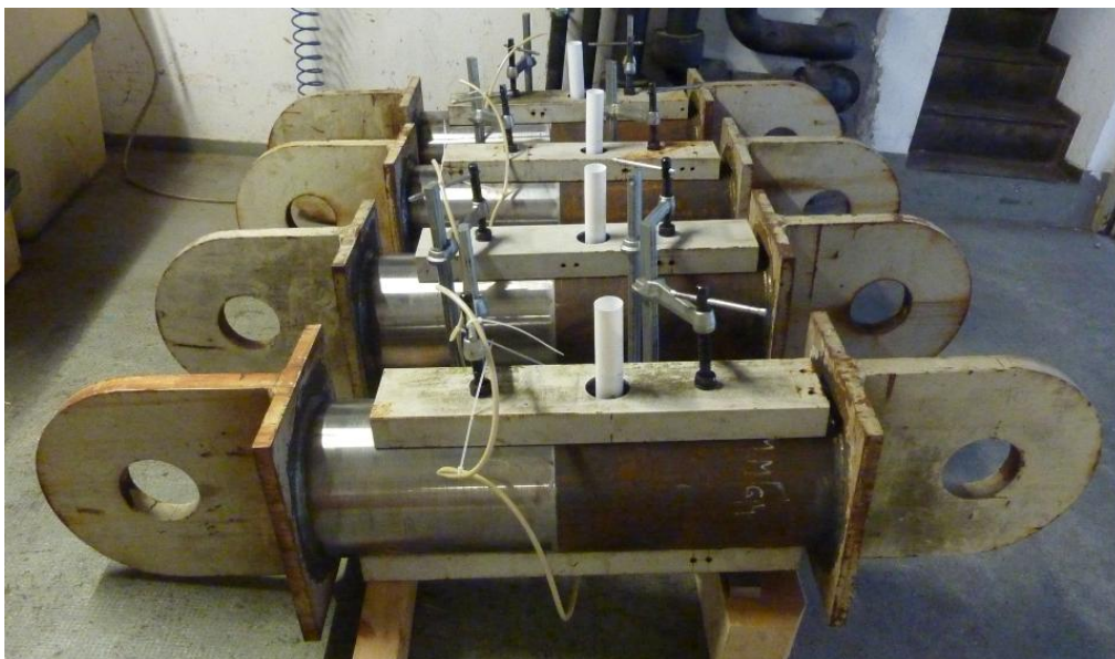
Abbildung 6.11 Klebtechnische Fertigung der Großrohrproben Konfiguration D
