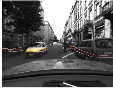
Abb. 4.2.: Neben den Objektmerkmalen gegeben durch die Laserscanner-ECU (Geschwindigkeit, Distanz, etc.) werden für jedes Objekt die Farbeigenschaften in Form von Farbe, Sättigung, Helligkeit und Kontrast bestimmt. Über einen *C4.5 Entscheidungsbaum* wird anhand dieser Merkmale gelernt, wie visuell ansprechend (*[salient]* oder *[nicht salient]*) ein bestimmtes Objekt für den Fahrer ist .
