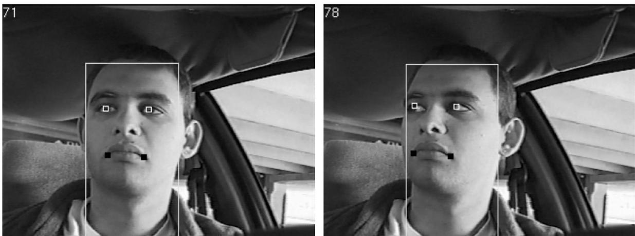
Abb. 2.3.: Smith et al. realisieren ein sehr schnelles Verfahren für eine grobe Schätzung der Kopffrotation, indem sie die perspektivische Verschiebung der Augen und der Mundwinkel relativ zur Gesichtsfläche ermitteln. Als Kopfpose wird die grobe Orientierung über die Klassen *[rechts]*, *[links]*, *[geradeaus]*, *[oben]* und *[unten]* bestimmt. Quelle: [SSd00]
