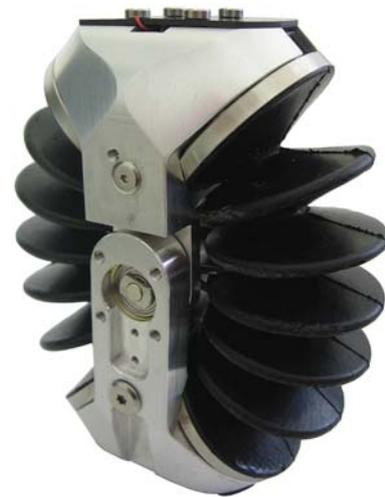
Abb. 6.3.: Nachgiebiges Antriebsmodul mit flexiblen Fluidaktoren
