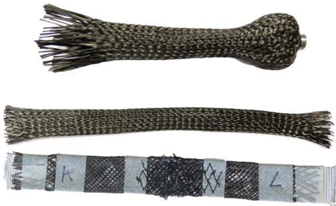
Schritt 1: Faservorformlinge für ein doppelwirkendes Festkörpergelenk
