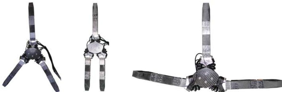
Abb. 6.13.: Symmetrische (Links), parallele (Mitte) und lineare (Rechts) Grundstellung der Greiferbasis
