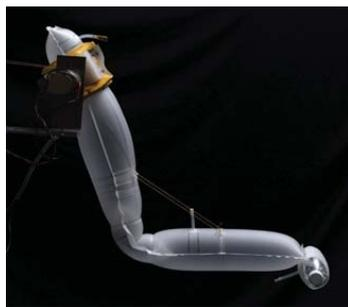
Abb. 1.46.: Aufblasbarer Roboterarm für die Servicerobotik<sup>14</sup>
