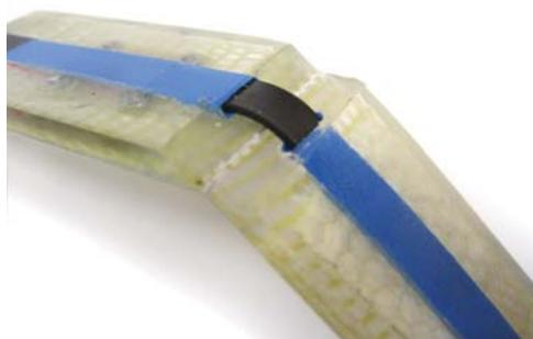
(d) Testgelenk mit flexiblem Magnetband
