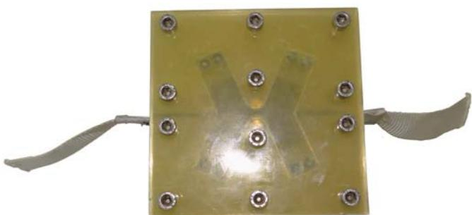
Schritt 5: Für die Harzinjektion vorbereitetes VARTM-Werkzeug
