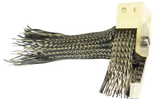
Schritt 2: Gelenkvorformling für die Aktoraufnahme
