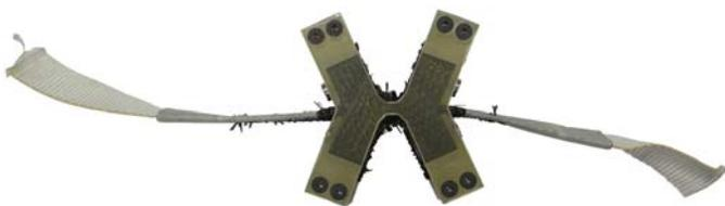
Schritt 3: Ausrichtung und Fixierung der Vorformlinge in der eigentlichen Gelenkanordnung
