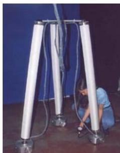
(a) Roboter mit entleerten Strukturelementen
