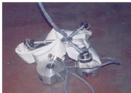
(b) Roboter mit befüllten Strukturelementen
