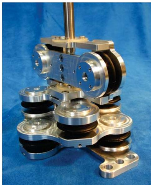
Abb. 6.19.: Zwei Segmente einer rüsselförmigen Roboterstruktur
