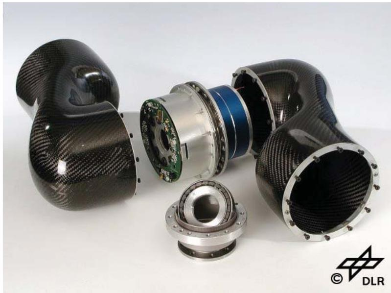
Abb. 1.4.: CFK-Segmente des DLR-LBR III
