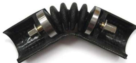
(c) Längsschnitt durch ein Fingerglied mit Aktor
