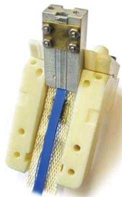
(b) Schmalgewebe, Sensorplatine und Führungskanal im VARTM-Werkzeug
