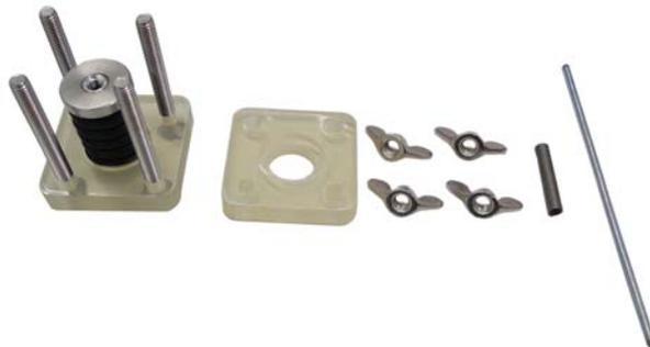
(b) Vorrichtung zur Montage der Rückstellfeder
