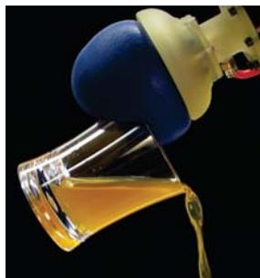
Abb. 1.40.: Vakuumbreifer nach Brown et al. [55]
