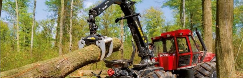
Abbildung 6: Skidder bei der Holzmanipulation
