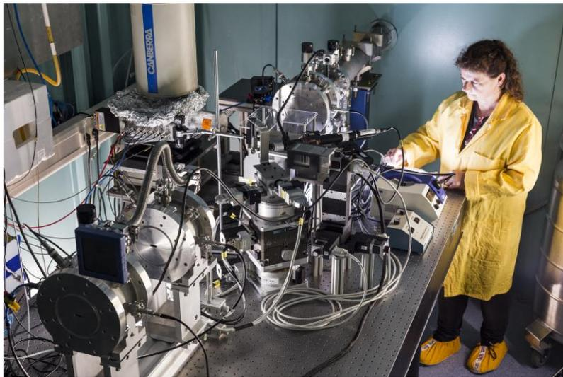
Abb. 14 Messaufbau an der INE-Beamline für Actiniden-Forschung an der Synchrotronstrahlungsquelle ANKA
