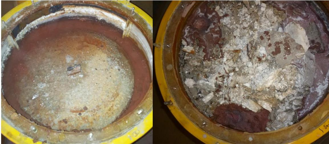
a) Probekörper #35 nach 25.3 Jahren Auslaugung in NaCl-Lösung      b) Probekörper #36 nach 23.3 Jahren Auslaugung in MgCl<sub>2</sub>-Lösung
