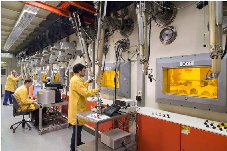
Abb. 12 Abgeschirmte Boxenlinie im INE
