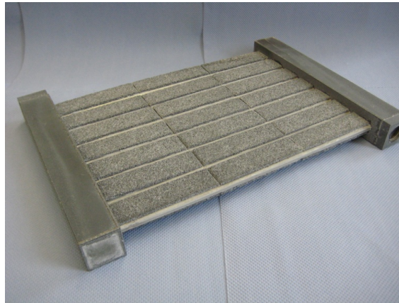
Abbildung B.3.: Am Fraunhofer ISE entwickelter Demonstrator eines einzelnen fluiddurchströmten Adsorberelements (Bildquelle: Fraunhofer ISE)
