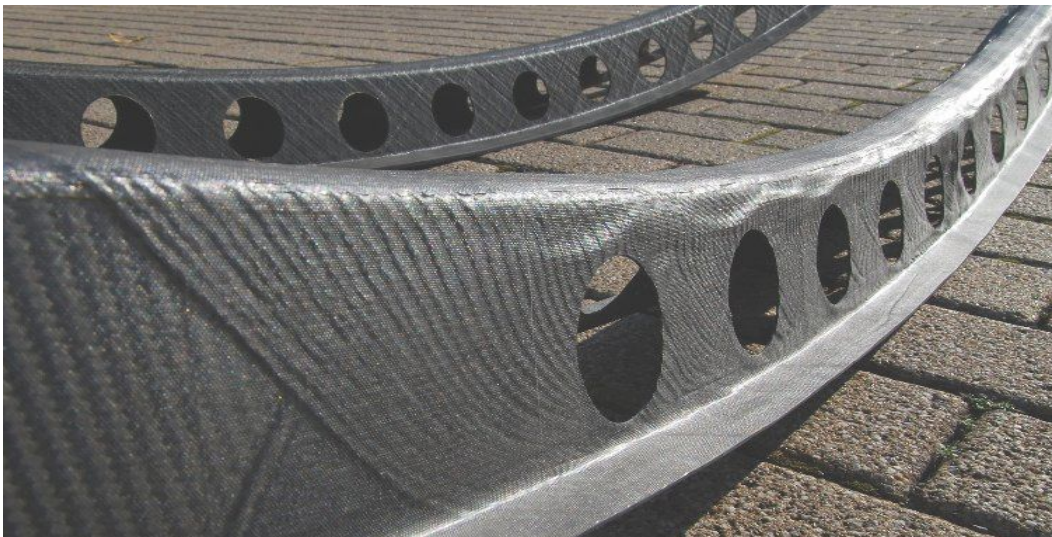
Bild 12.15. Demonstratorbauteil „Omega-Spant“, gefertigt am IFP, Dresden. Im Vordergrund: CAIO-Spant, im Hintergrund: Standard-Multiaxialgelege.
