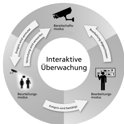
Abbildung 5.2: Grundsatz der interaktiven Überwachung
