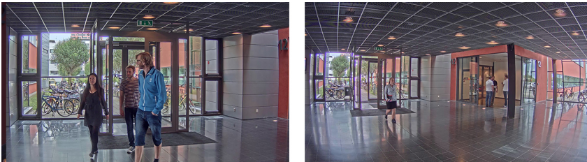
Abbildung 7.3: Vergleich des Erfassungsbereichs zwischen Tele- und Weitwinkelobjektiv, ©Axis Communications
