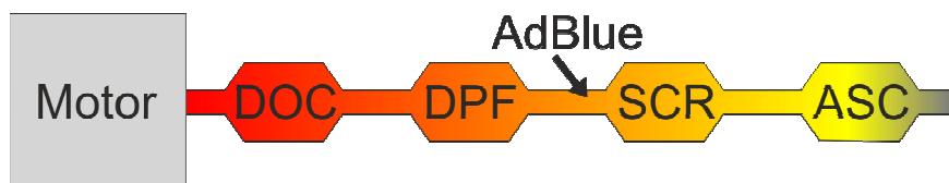
Abbildung 2: Schematischer Aufbau des Abgasstrangs eines Dieselfahrzeugs mit SCR-Technologie mit DOC zur Oxidation von CO und teilweise NO und HC, gefolgt vom DPF zur Partikelabscheidung und SCR zur NO x -Entfernung, sowie ASC zur Minderung des NH 3 -Schlupfs.
