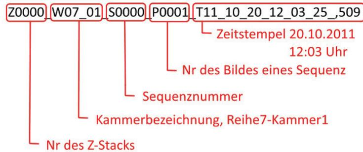
Abb. 4.4.: Beispiel der Dateibenennung der Bilder des Parallelmikroskops (nach [122])
