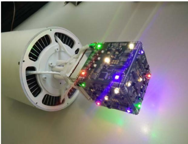
Abb. 1: Bild des MTS ohne Diffusor und Abdeckung, ausgerüstet mit unterschiedlichen farbigen, sowie warmweißen und kaltweißen LEDs
