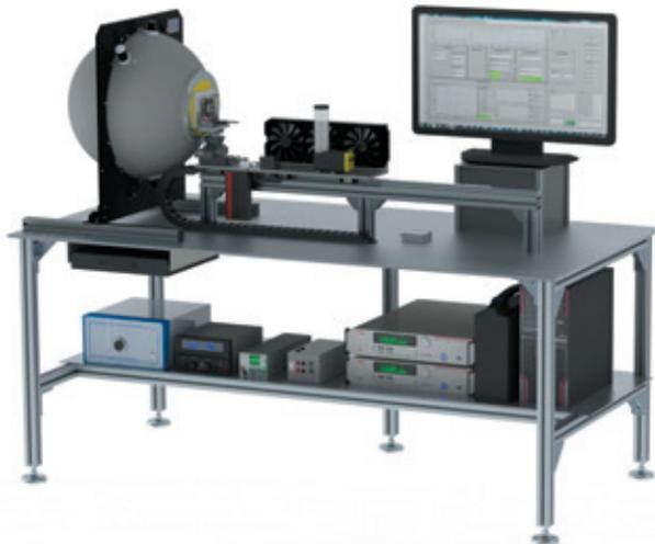
Abb. 2: Gerenderte 3D-Darstellung des Messplatzes.
