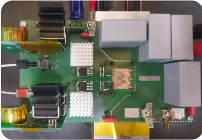
Abb. 4: Foto des Halbbrückenwechselrichters mit dem SMPD Modul, dem Modulkühlkörper, den Gate-Treiber-ICs mit dazugehörigem Kühlkörper, der Gate-Treiber-Versorgungen und dem DC-Zwischenkreis.
