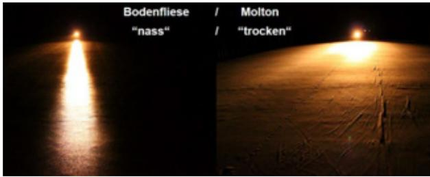
Abb. 5: Vergleich der resultierenden Lichtverteilungen für Bodenfliese (links) und Moltonstoff (rechts) /10/
