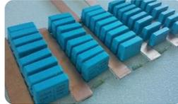
Abb. 5: Foto des Resonanzkondensators  $C_{res}$ , bestehend aus Polypropylen-Kondensatoren in Reihenparallelschaltung mit einer Gesamtkapazität von 5,5 nF.
