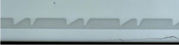
Abb. 5: Beispiel eines Schnittes durch eine realisierte Mikrostruktur
