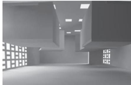
Abb. 8: Tageslichtberechnung mit Oberlichter und Lern-Kuben (D=1.6%)
