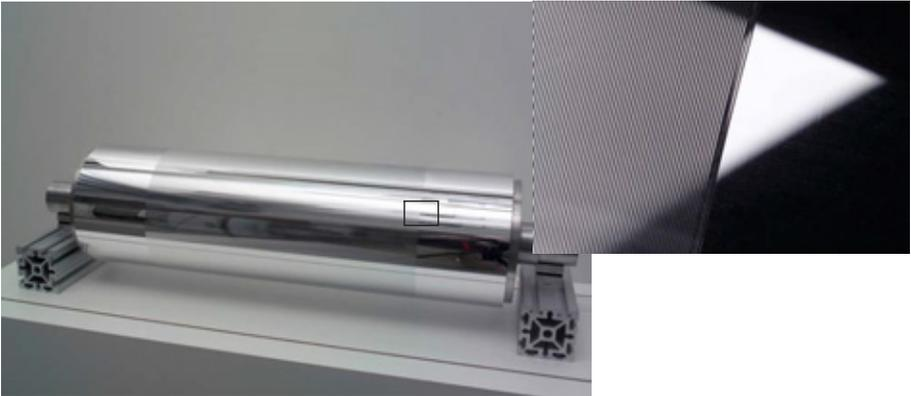
Abb. 6: Erstes Master-Werkzeug mit den Diamant-geprägten Präzisionsstrukturen
