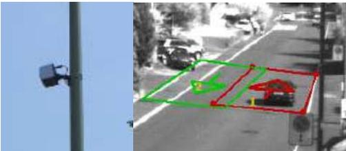
Abb. 4: Verkehrs-Sensor und Messfeld
