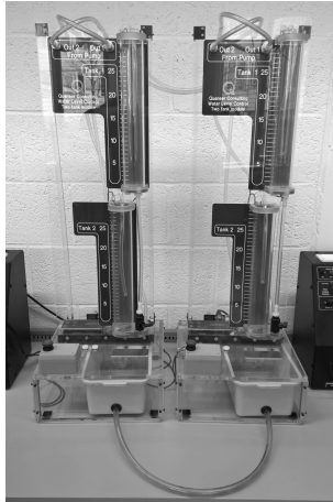
Bild 1: Das Viertanksystem am Lehrstuhl für Regelungstechnik der TU München.
