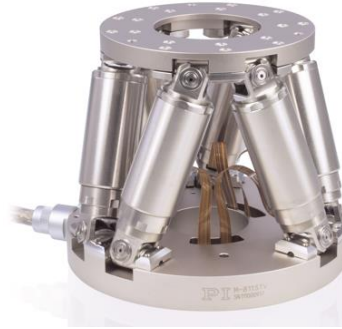
(b) H-811 6-Achsen-Miniatur-Hexapod von Physik Instrumente (PI) [41]
