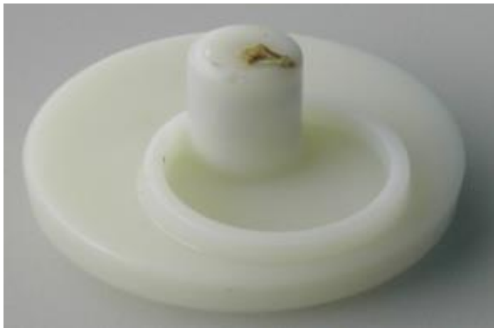
Abbildung 2.25: Dieseleffekt. (Quelle: Eurecat)
