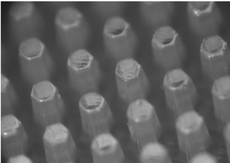
Abbildung 2.23: Echtes Bild des Belüftungsproblems (Quelle: Eurecat)
