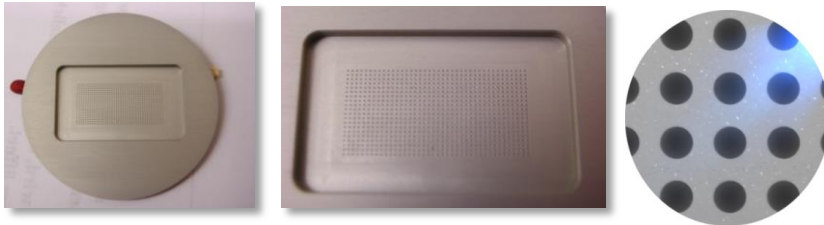
Abbildung 4.16: Sonden-Karte und 60-fache Vergrößerung von Bohrlochern
