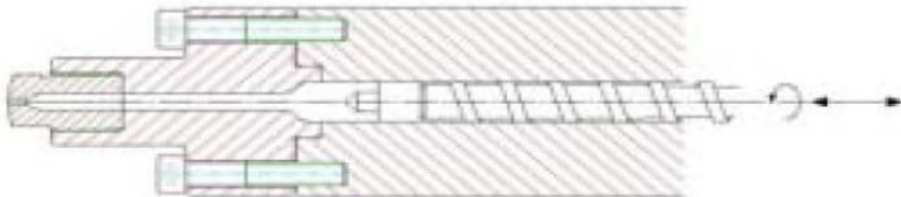
Abbildung 2.32: Herkömmliche skalierte Schnecke. (Quelle: Wittmann-Battenfeld)
