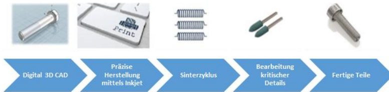
Abbildung 3.11: Prozessablauf für Metal-3D-Printing. Quelle: Voxeled Materials.
