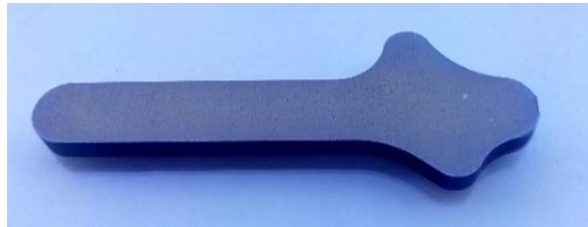
Abbildung 6.9: Profil gefertigt durch Drahterodieren.
