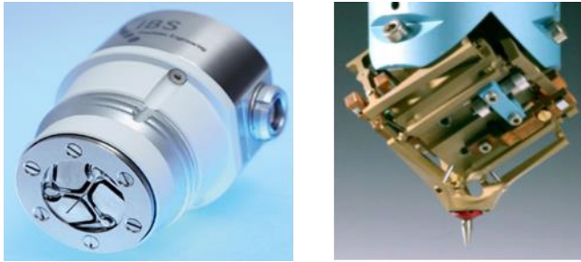
Abbildung 8.4: IBS Triskelion [17] und METAS Mikro-KMG-Sonden[24].
