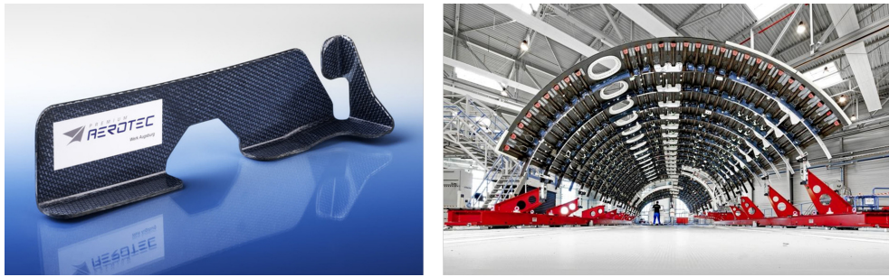
Abbildung 2.6: Halteclip, hergestellt aus endlosfaserverstärkten PPS-Halbzeugen, und Zusammenbau in der Rumpfschale eines A350-XWB [39]
